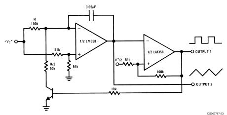
\*WIDE CONTROL VOLTAGE RANGE: 0  $\rm V_{DC} \le \rm V_{C} \le 2~(V^{+}$  –1.5V  $_{DC})$
